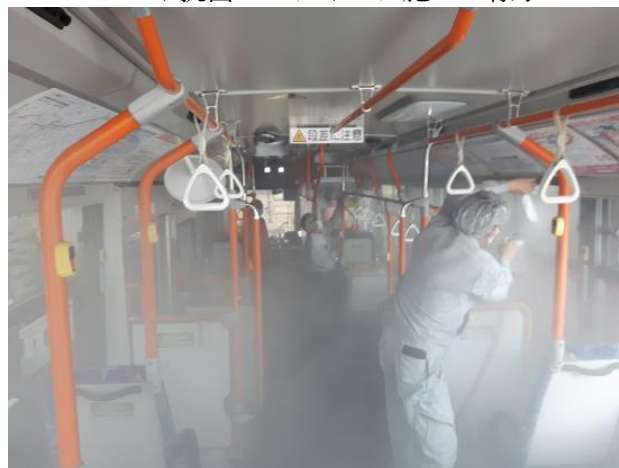
▼抗菌コーティング施工の様子
